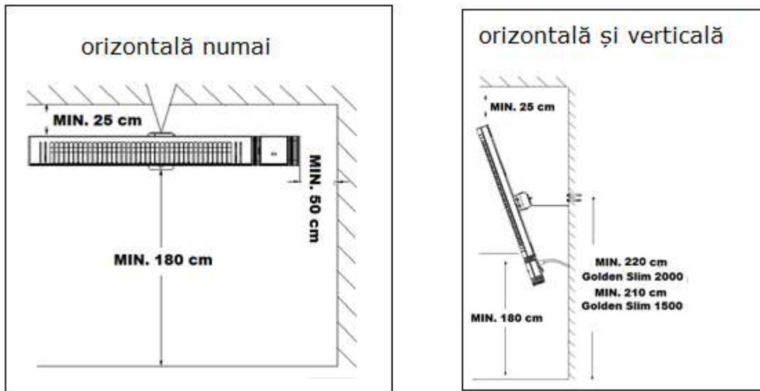
Panoul radiant cu infraroșu Golden Slim este prevăzut cu un suport de perete mobil, astfel că poate fi folosit atât pe orizontală cât și pe verticală. Acesta necesită atenție specială la instalare, deoarece în orice poziție ați monta aparatul trebuie să țineți cont de distanțele minime până la perete, plafon și sol:
