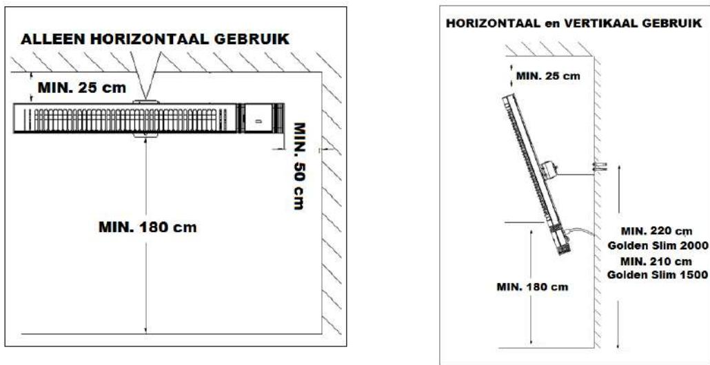
De Golden Slim infraroodstraler is voorzien van een draaibare muurbeugel zodat horizontaal en verticaal gebruik mogelijk is. Dit vereist speciale aandacht bij het installeren omdat in alle mogelijke posities van het apparaat rekening moet worden gehouden met minimale afstanden tot muur, plafond en de grond:
