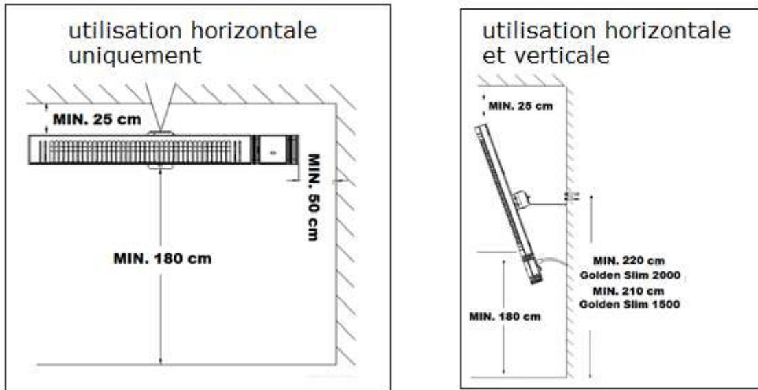
Le radiateur à infrarouge Golden Slim est doté d'un support mural tournant permettant une utilisation horizontale et verticale. La présence de ce support requiert une attention particulière lors de l'installation puisque toutes les positions possibles de l'appareil doivent tenir compte des distances minimales par rapport au mur, au plafond et au sol.
